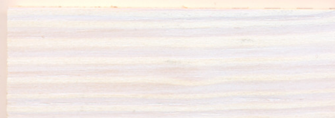
Effetto Semicoprente - Semi-covering effect (Kemismalt diluito con acqua 1:1 - with water 1:1) Impregnante Trasparente 2034 + Kemismalt 3430 BIANCO RAL 9010 Impregnating agent 2034 + Kemismalt 3430 White color RAL 9010
